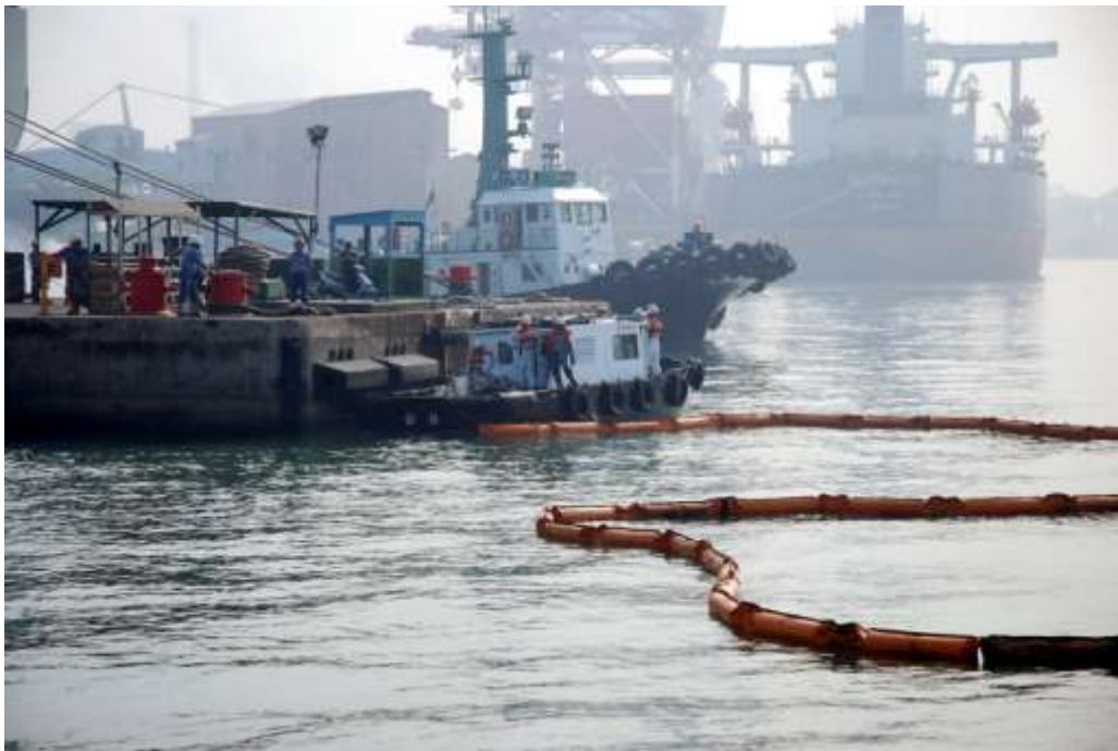
Step 10: 攔油除污作業－執行機動截源作業。
