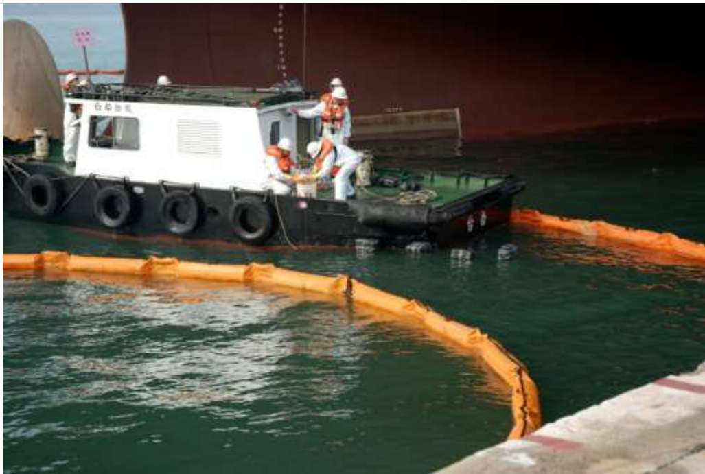
Step 9: 攔油除污作業－執行包抄作業及建置緩衝區。
